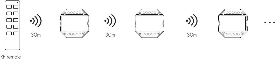
**Trasmissione automatica:** Un ricevitore può trasmettere i segnali del telecomando a un altro ricevitore entro 30 m. Finché c'è un ricevitore entro 30 m, la distanza del telecomando può essere estesa.
